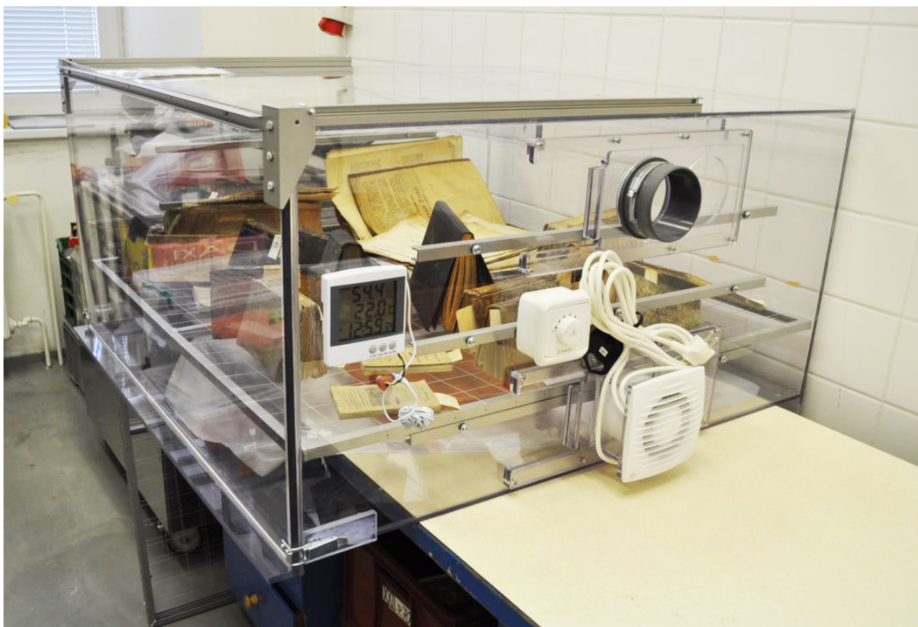
Obr. 3: Dezinfekcia v parách butanolu
